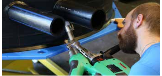
使用新型 45°和 90°角转接器可以实现原本不可企及的焊接。
